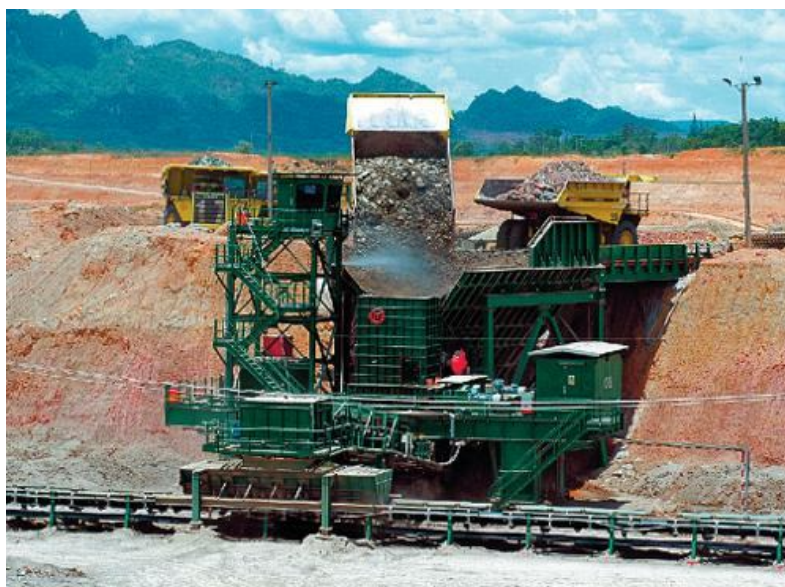
Рис. 3. Передвижная дробильная станция (вскрышные породы) производительностью 5500 т/час (Таиланд)
