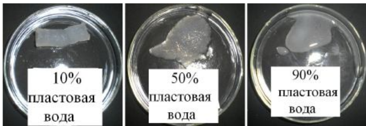
Рис. 7. Трансформация геля в состояние золя для 2%-ного раствора геллана в присутствии различных концентраций пластовой воды.
