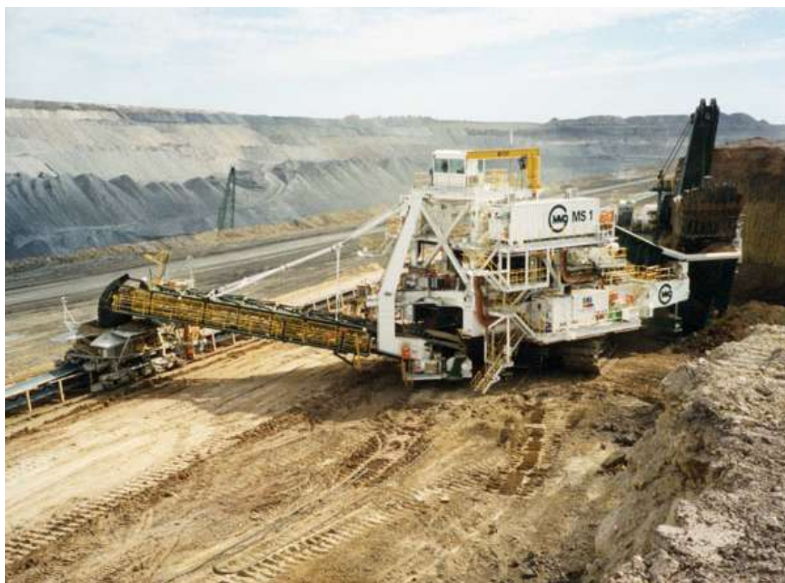
Рис.1. Работа комплекса экскаватор – дробилка – конвейер.
