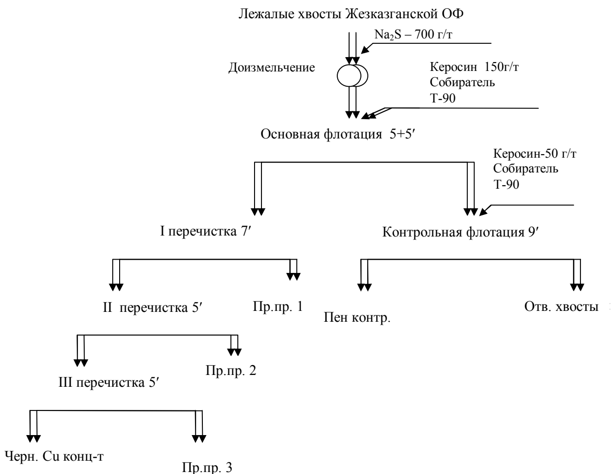
Рис. 2. Схема флотации хвостов обогащения Жезказганской обогатительной фабрики с получением черного медного концентрата
