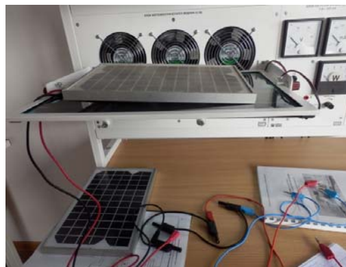
2-сурет. Фотомодульдің шаң басуына байланысты зерттелуі
