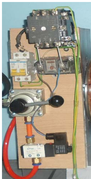
Рис. 6. Схема подключения электропневматического золотника
