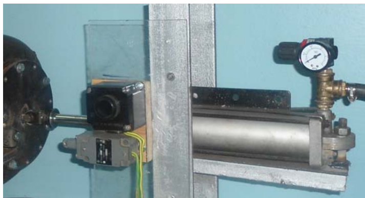
Рис. 7. Установка регулируемого байпаса
