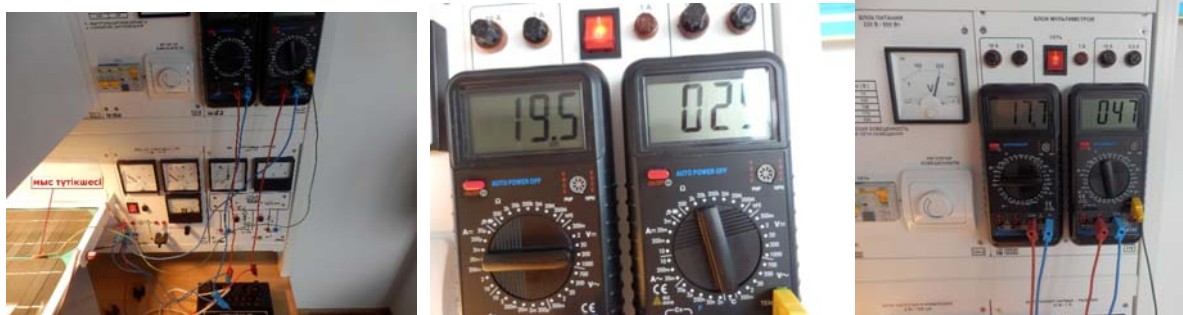
1-сурет. Фотомодульдің температураға байланысты E=500 \text{ Вт/м}^2 жарық тығыздығы кезіндегі зерттелуі.
