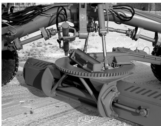
Рис. 3. Рабочее оборудование автогрейдера
