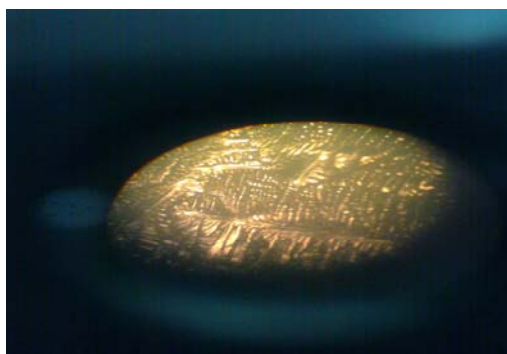
Рис. 12. Микроструктура образца после экструзии в течение приведенного времени равного 0.82
