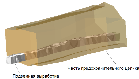
Рис. 1. Каркасные модели подземной выработки и предохранительного целика
