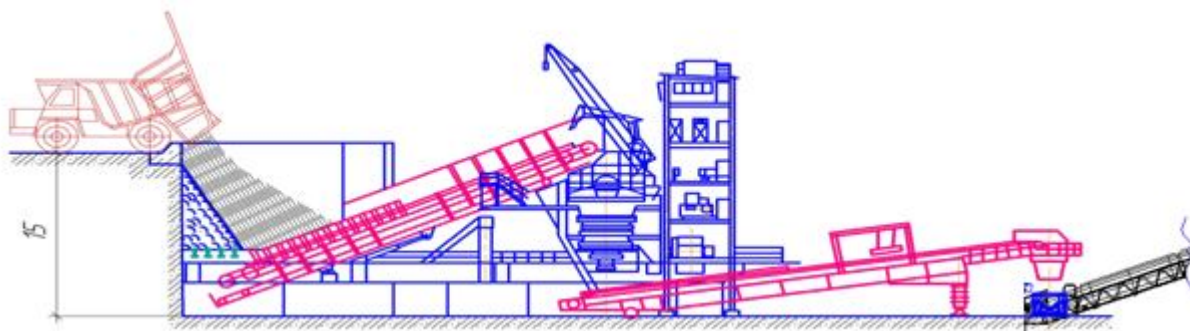
Рис. 8. Схема установки полустационарной дробилки на карьере
