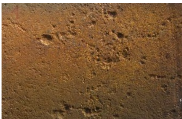
Рис. 3. Коррозия емкостей под горячую воду (баки-аккумуляторы ГВС)
