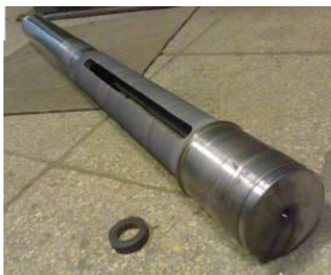
Рис. 4. Восстановленный шток гидравлической системы бурового оборудования хромельникелевым покрытием ПГ-7 Ю-НХ
