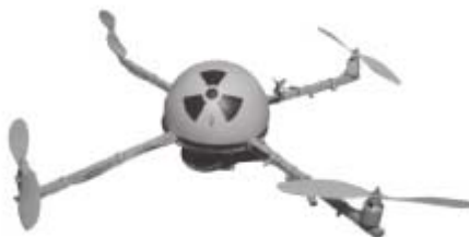
Рис. 1. Квадрокоптер с повышенной радиационной устойчивостью.
