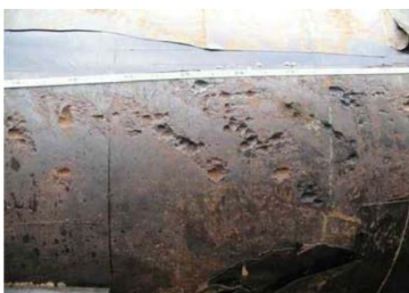
Рис. 2. Коррозия трубопроводов под изоляцией
