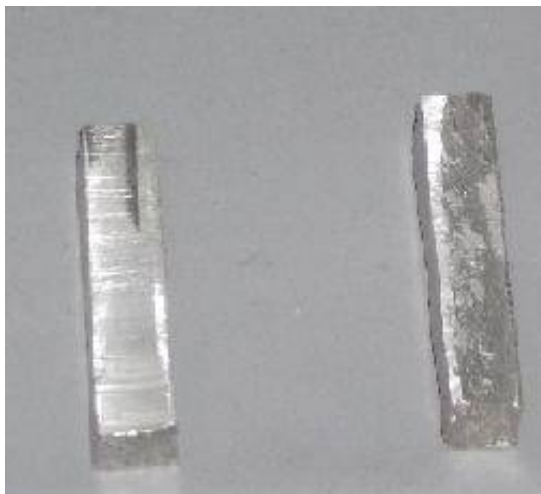
2-сурет. Микродоғалы тотықтыруға арналған үлгілер
