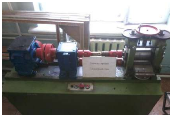
4-сурет. Илемдеу орнағы және илемденген үлгінің көрінісі
