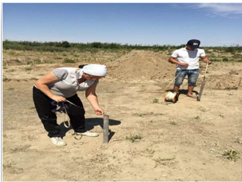
Рис. 4. Замеры уровней грунтовых вод в скважинах- пьезометрах на экспериментальном участке исследований
