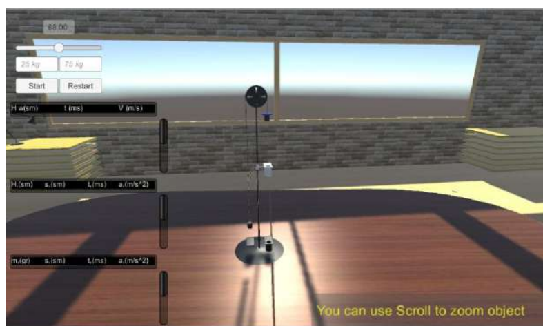
Рис. 3. Выполнение виртуальной лабораторной работы «Изучение законов кинематики и динамики на машине Атвуда»
