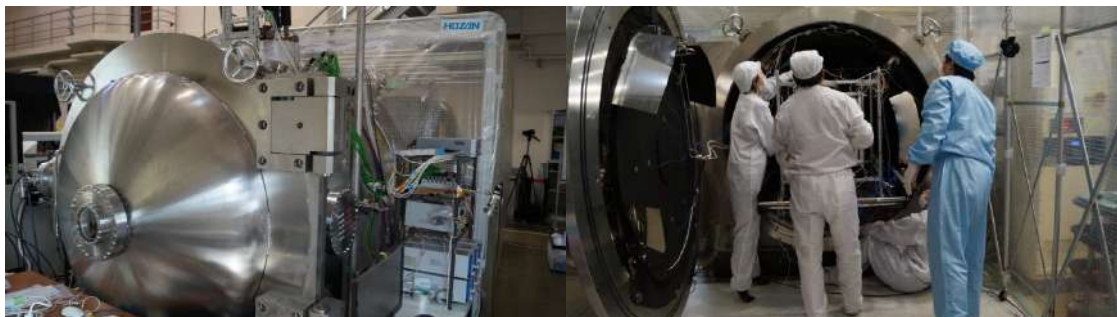
Рис. 1. Вакуумная камера в Center of Nanosatellite Testing
