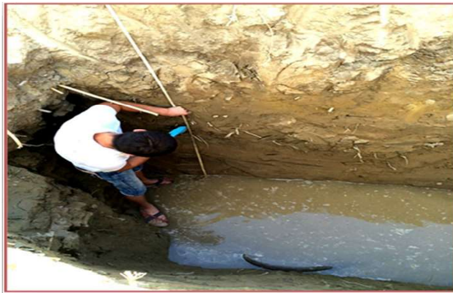
Рис. 3. Измерение динамического уровня воды в мини-бассейне.
