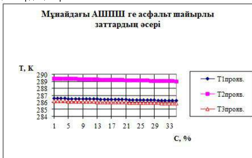
1-сурет. Мұнайдың құрамында болатын табиғи еріткіштердегі смоланың белгілі бір пайыздық мөлшерінде АШПШ-ның пайда болуы.
