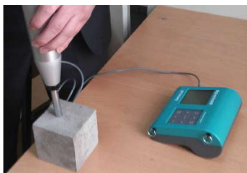
2-сурет. DIGI-SCHMIDT 2000 маркалы тексеру балғасымен бетон беріктігін анықтаудадағы зерттеу нәтижелері
