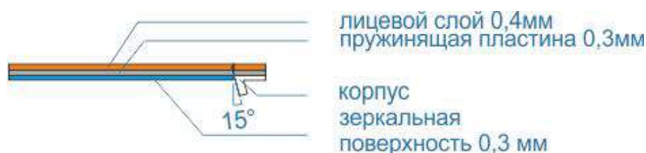
Рис. 4. Схематический разрез клавиши
