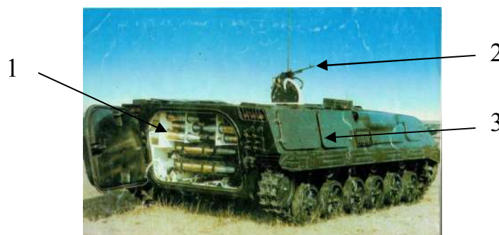
Рис. 3. ABAL машина подвоза боеприпасов: 1 - грузовой отсек хранения боеприпасов, 2 – пулемет, 3 - боковые люки.
