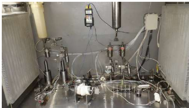
Рис. 3. Установка для исследования кернов УИК-С(2)
