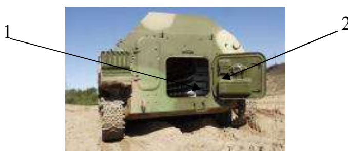
Рис. 2. Транспортно-заряжающая машина ТЗМ-122: 1 - грузовой отсек хранения боеприпасов, 2 - задний люк.
