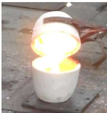
Рис.1. Внепечной способ заливки расплава для модифицирования
