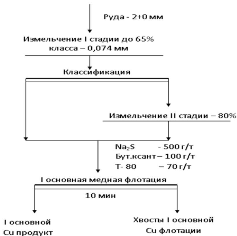
Рис. 2. Схема открытых опытов по подбору измельчения II стадии
