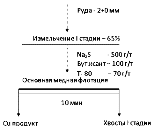
Рис. 1. Схема открытых опытов по подбору измельчения I стадии
