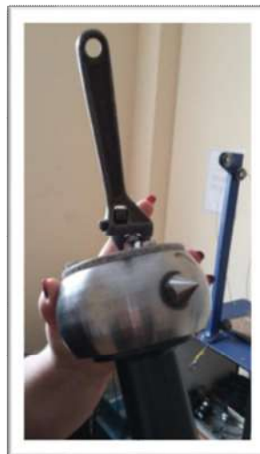
Рис. 5. Способ регулировки острия бойка
