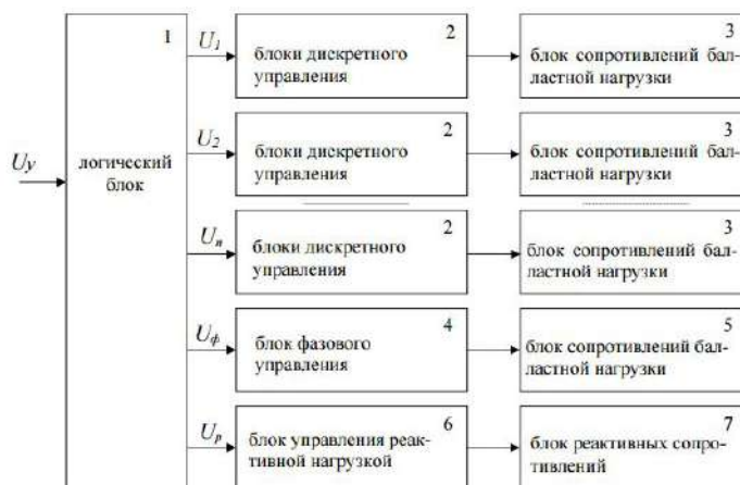
Рис. 4. Устройство для регулирования частоты напряжения генератора
