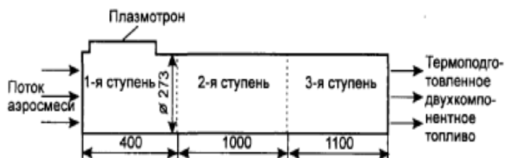
Рис. 3. Схема цилиндрической камеры ЭТХПТ
