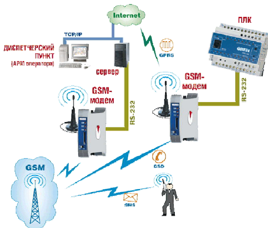
Рис. 5. Структурная схема мониторинга технологических процессов
