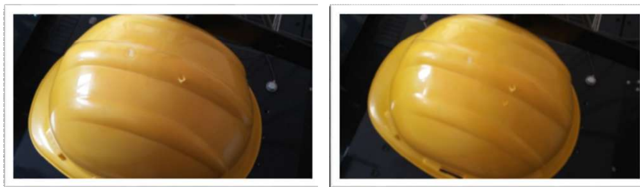
Рис. 7. Результаты испытания каски на перфорацию
