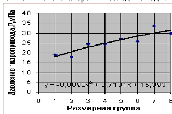
Рис. 6. Зависимость давления в гидроприводе ОЭ от размерной группы
