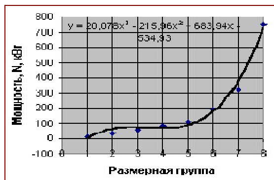
Рис. 2. Зависимость мощности двигателя ОЭ от размерной группы
