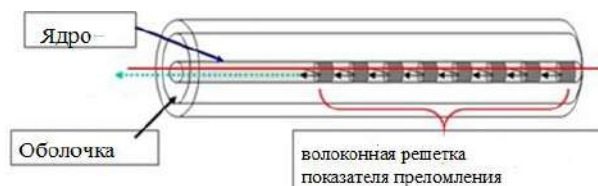
1-сурет. Талшық өзегіндегі оптогалшықты Брэгг торы
