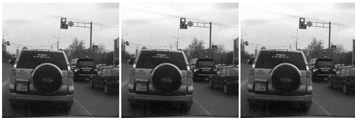
Рис. 3. Слева направо: изображение, зашумленное белым шумом ( \sigma = 0.1 ); реконструкция изображения с использованием жесткой пороговой оценки в области вейвлет-преобразования (SNR=19.67[dB]); реконструкция изображения жесткой пороговой оценкой в области САВП (SNR=20.24[dB])
