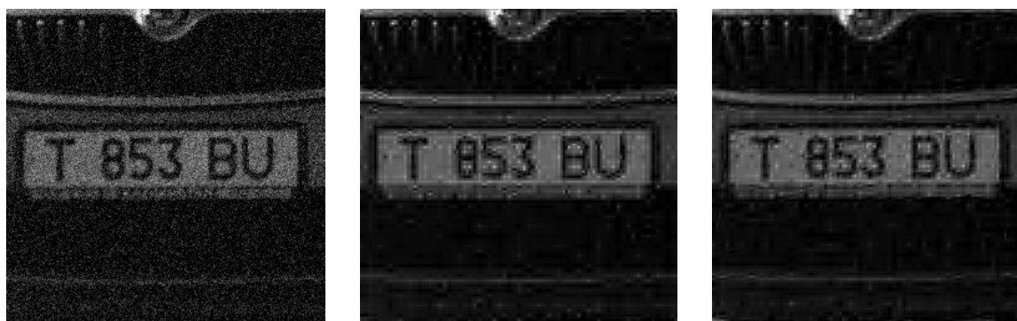
Рис. 5. Слева направо: изображение, зашумленное белым шумом ( \sigma = 0.1 ); реконструкция изображения с использованием жесткой пороговой оценки в области вейвлет-преобразования (SNR=8.82 [dB]); реконструкция изображения жесткой пороговой оценкой в области САВП (SNR=9.92[dB])
