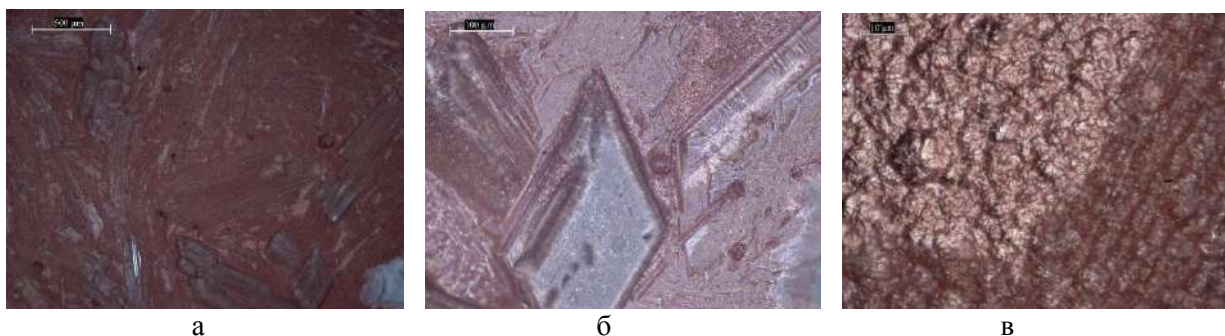
Рис.1. Микрофотографии медного покрытия, полученного при U=1 В, I=0,07 А: а) увеличение 500 мкм; б) увеличение 100 мкм; в) увеличение 10 мкм
