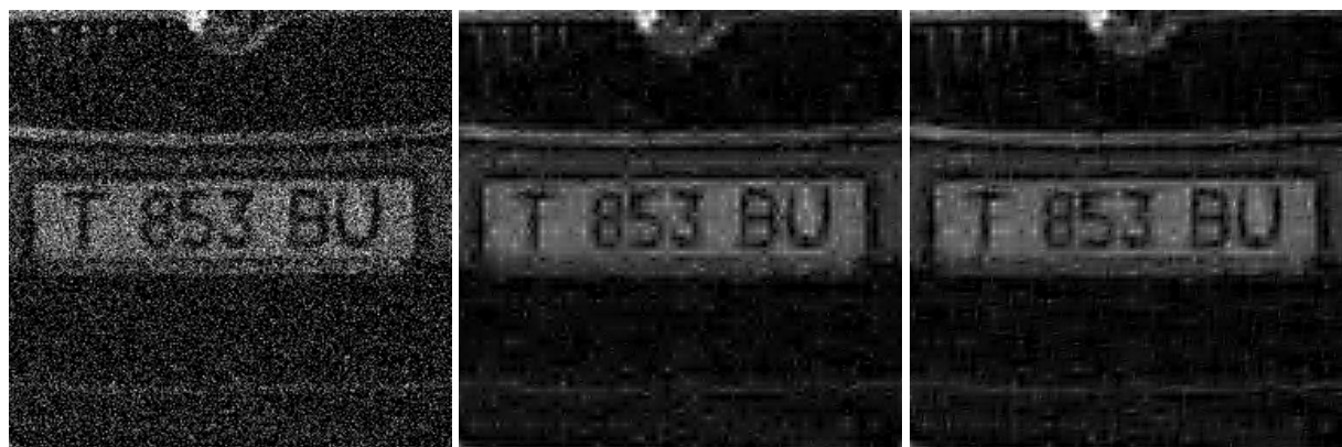
Рис. 10. Слева направо: изображение, зашумленное белым шумом ( \sigma = 0.2 ); реконструкция изображения с использованием мягкой пороговой оценки в области вейвлет-преобразования (SNR=7.24[dB]); реконструкция изображения мягкой пороговой оценкой в области САВП (SNR=7.78[dB])
