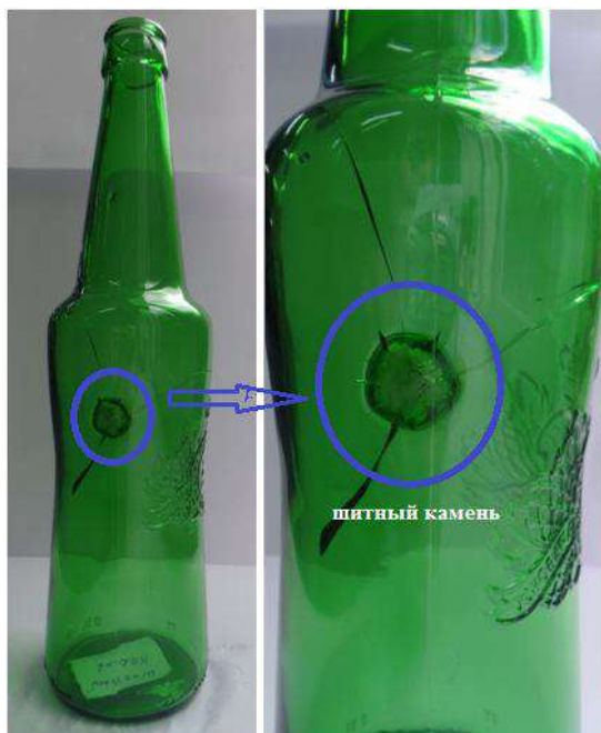
Рис. 4. Инородные включения (разрушение огнеупора) в зеленом тарном стекле, производимом на ТОО «ЕвроКристалл»
