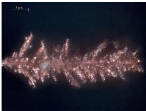
Рис.3. Микрофотография порошка меди полученного в ультразвуковой ванне с катодом покрытой фильтровальной бумагой
