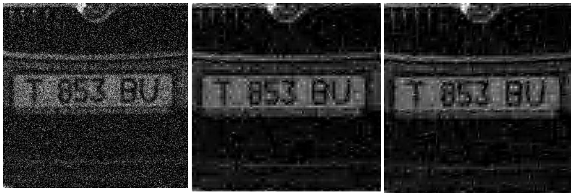
Рис. 6. Слева направо: изображение, зашумленное белым шумом ( \sigma = 0.2 ); реконструкция изображения с использованием жесткой пороговой оценки в области вейвлет-преобразования (SNR=6.33[dB]); реконструкция изображения жесткой пороговой оценкой в области САВП (SNR=6.79[dB])
