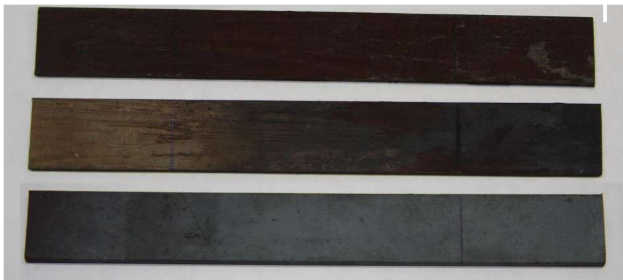
Рис. 1. Изменение оксидного слоя на поверхности ленты в зависимости от атмосферы, в которой она изотермически выдерживается в течение 6 часов при 320°C (сверху вниз серная, соляная, смесь серной и соляной кислот)
