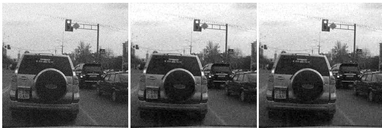
Рис. 4. Слева направо: изображение, зашумленное белым шумом ( \sigma = 0.2 ); реконструкция изображения с использованием жесткой пороговой оценки в области вейвлет-преобразования (SNR=16.04[dB]); реконструкция изображения жесткой пороговой оценкой в области САВП (SNR=16.20[dB])
