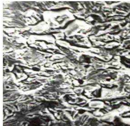
2-сурет. 09Г2С болатының тігісінің беттік аймағындағы құрылымы, үлкейту, x 250
