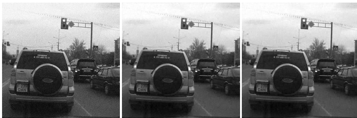
Рис. 7. Слева направо: изображение, зашумленное белым шумом ( \sigma = 0.1 ); реконструкция изображения с использованием мягкой пороговой оценки в области вейвлет-преобразования (SNR=21.41[dB]); изображение, реконструированное мягкой пороговой оценкой в области САВП (SNR=21.84[dB])
