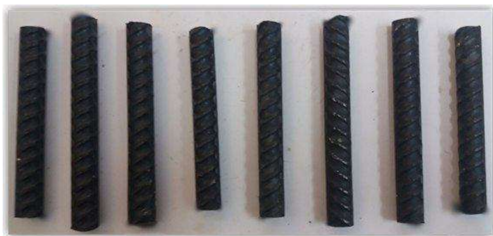
Рис. 5. Полученные опытные образцы арматурного профиля №12
