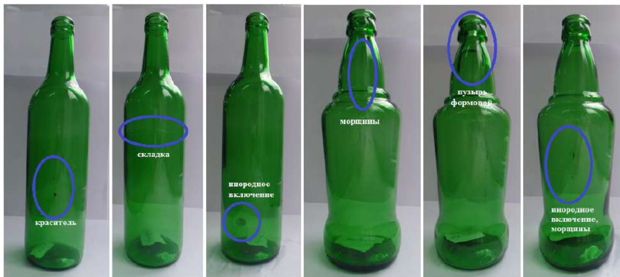
Рис. 3. Специфические дефекты в зеленом тарном стекле
