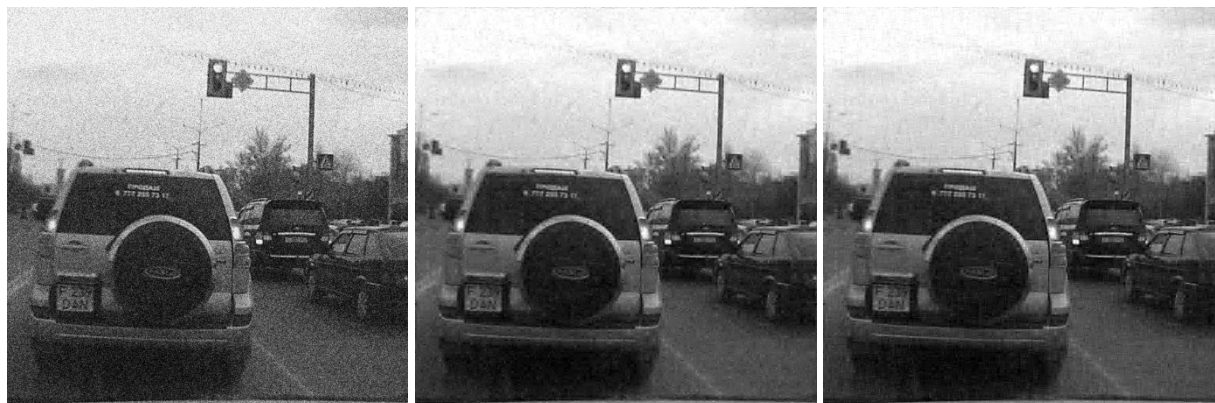
Рис. 8. Слева направо: изображение, зашумленное белым шумом ( \sigma = 0.2 ); реконструкция изображения с использованием мягкой пороговой оценки в области вейвлет-преобразования (SNR=17.86[dB]); изображение, реконструированное мягкой пороговой оценкой в области САВП (SNR=17.86[dB])
