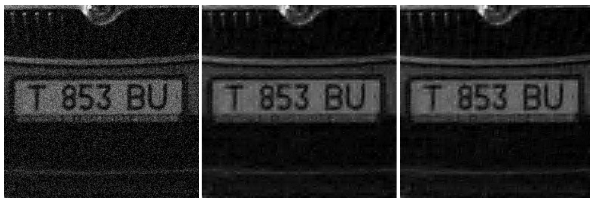
Рис. 9. Слева направо: изображение, зашумленное белым шумом ( \sigma = 0.1 ); реконструкция изображения с использованием мягкой пороговой оценки в области вейвлет-преобразования (SNR=10.46[dB]); реконструкция изображения мягкой пороговой оценкой в области САВП (SNR=11.16[dB])
