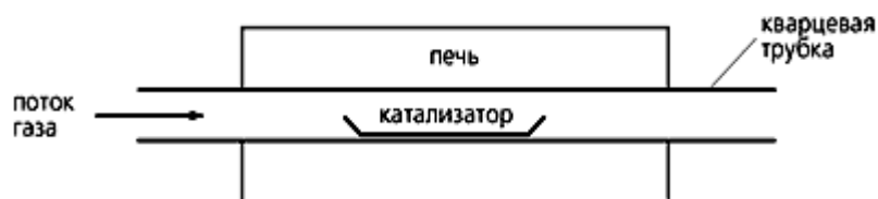
Рис. 1. Схема установки для получения нанотрубок методом химического осаждения
