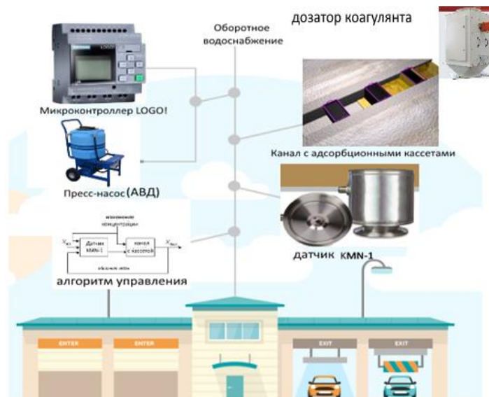
2-сурет. Автожуу құрылғылары мен қондырғылары бар КМН-1 көмірсутектердің қамтитын датчиктердің өзара әрекеттерінің схемасы
