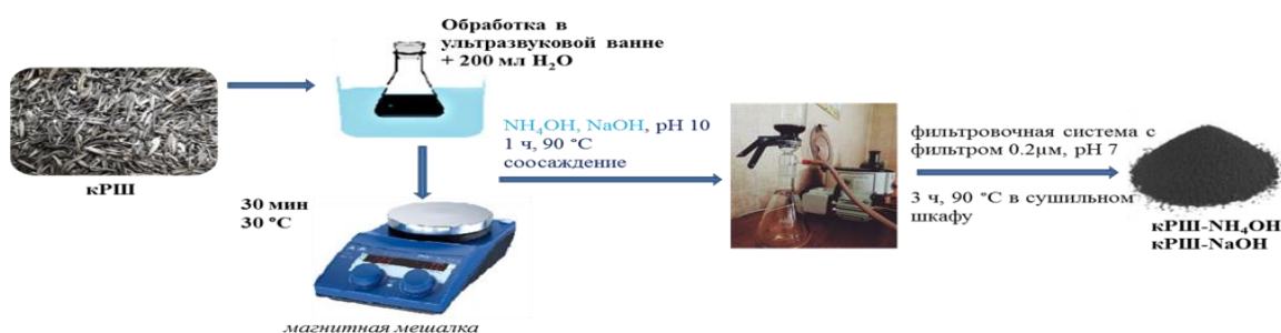
Рис. 3. Схема процесса соосаждения для получения сорбентов на основе кРШ.
