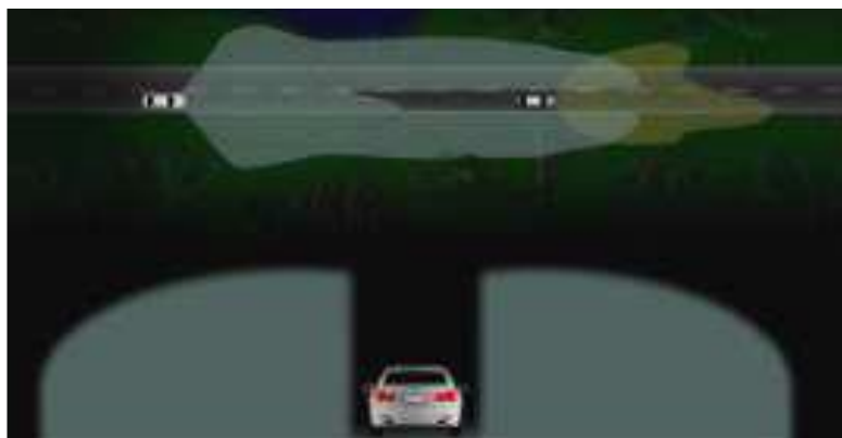
Рис. 9. Принцип работы светодиодных фар Matrix-LED
