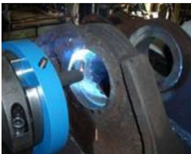
Рис. 3. Восстановление отколов проушин
