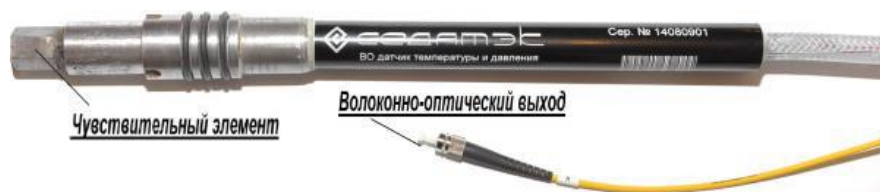
Рис. 2. Внешний вид волоконно-оптические датчиков температуры на основе волоконных решеток Брэгга
