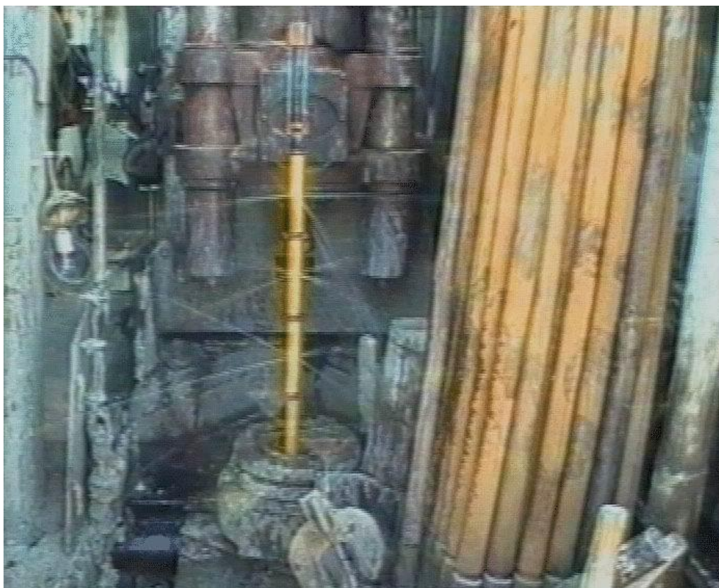
Рис. 2. Испытания гидровибрационного рабочего органа перед спуском в скважину
