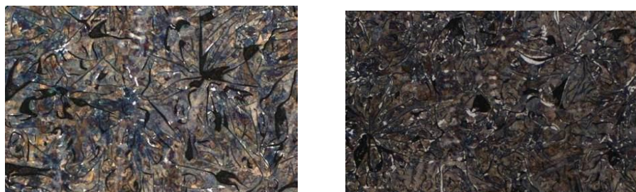
Рис. 1. Микроструктура стали 80ГСЛ (слева до микролегирования (W), справа после, травление 5% HNO 3 )
