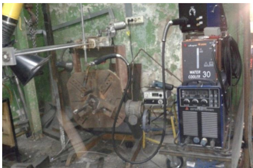
Рис. 5. Установка для наплавки (модель - AMI G500)
