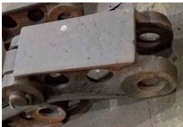
Рис. 3. Деформация звена цепи
