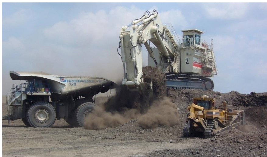
Рис. 15. Расчистка и выравнивание полотна забоя
