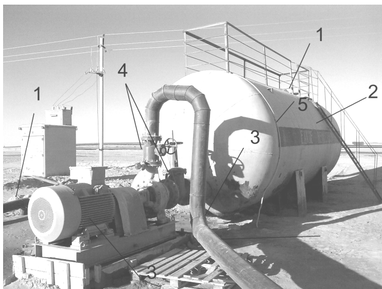
2-сурет. 1-сору ұңғымасының құбыры; 2-жасанды резервуар; 3- құю ұңғымасының құбыры; 4- винтильдер; 5-резервуардан ерітінді тасып кетпеуі үшін хабар беретін электронды тетік
