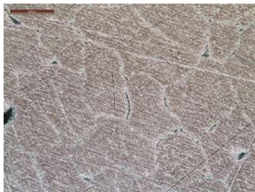
Рисунок 1. Микроструктура исходного алюминиевого сплава АД31, \times 100
