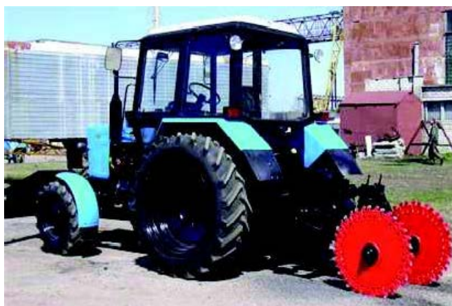
2-сурет. ЭТЦ-1609 шынжырлы экскаваторы үшін АНД-25 ауыстырмалы фрезерлі жұмыс органы
