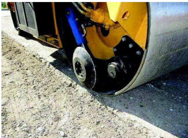
4-сурет. Асфальтбетон жабындылардағы тігісті кесу үшін жол катогына орналастырылған қосымша жабдық
