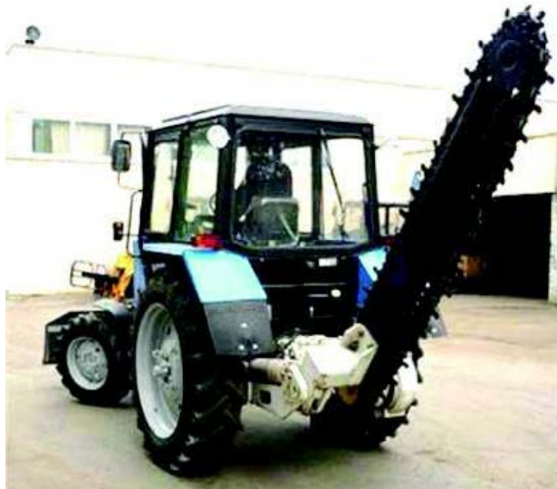
1-сурет. Дмитров экскаватор зауытының ЭТЦ-201 шынжырлы траншеялы экскаваторы
