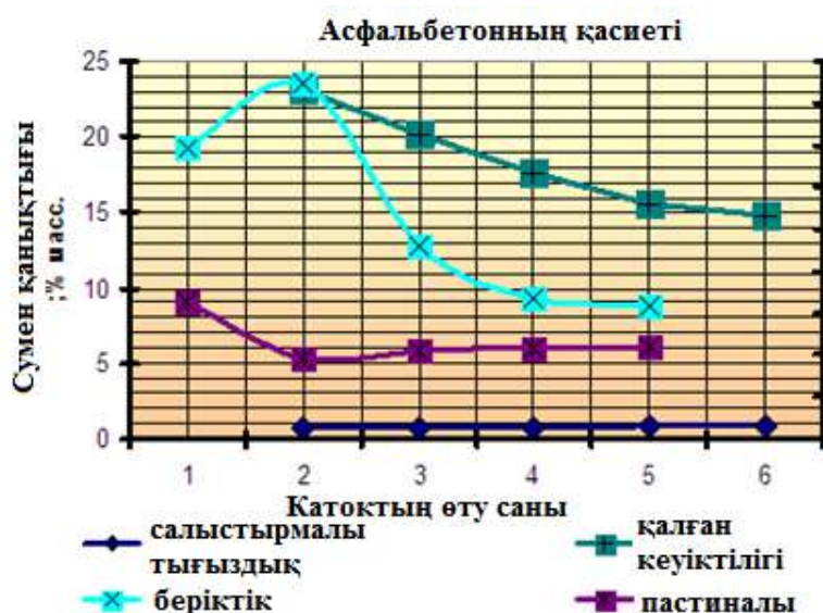
3-сурет. Тығыздау процесінде асфальтбетон қасиеттерінің өзгеруі
