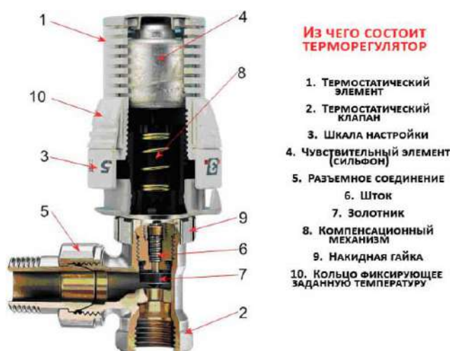
Рисунок 6. Устройство радиаторного терморегулятора
