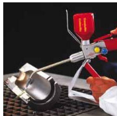
Рис. 5. Угол между газовой напылительной струей и защищаемой поверхностью
