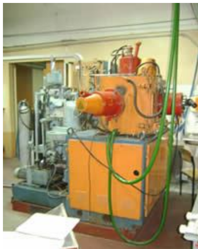
Рис. 2. Установка для комплексной ультразвуковой обработки осевых лезвийных инструментов.
