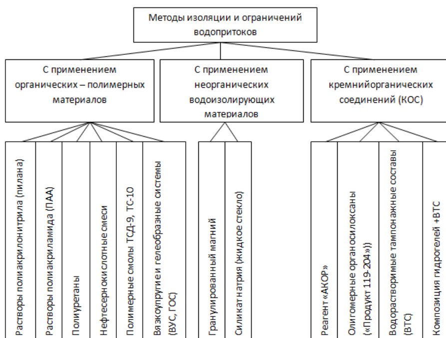
Рис. 1. Классификация основных методов ограничения и изоляции водопитокров
