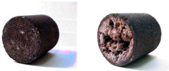
Рис. 1. Керн слева моделирует добычу воды, прокачиваемую через него ежедневно. Керн справа моделирует добычу воды, содержащую 0,12% (вес / объем) нитрата калия, прокачиваемую через него по понедельникам и 0,034% (вес / объем) натрия дигидрофосфата, прокачиваемую через него по средам и пятницам. Во вторник, четверг, субботу и воскресенье через него прокачивают воду. Обратите внимание на разрушение керна справа после обработки.
