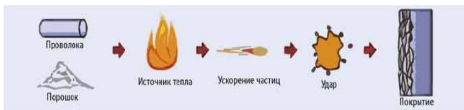
Рис. 1. Упрощенная схема нанесения порошков
