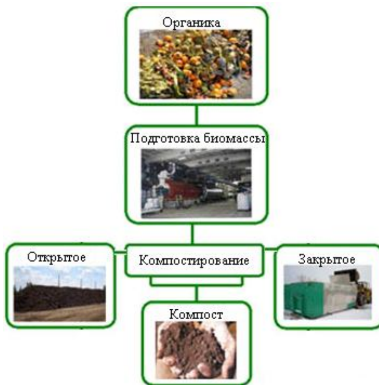
Рис. 2. Технологическая схема переработки органической фракции отходов [5]
