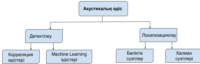
1-сурет. Акустикалық датчик негізіндегі жүйелердің жіктелуі
