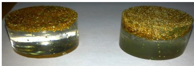
Рис. 6. Две пробы ионообменной смолы для анализа на микроскопе «OLYMPUS».
