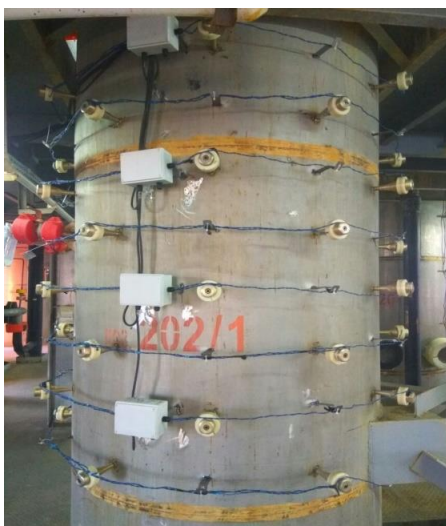
Рис. 3. УЗ излучатели, установленные управляемыми группами на СДК-1500
