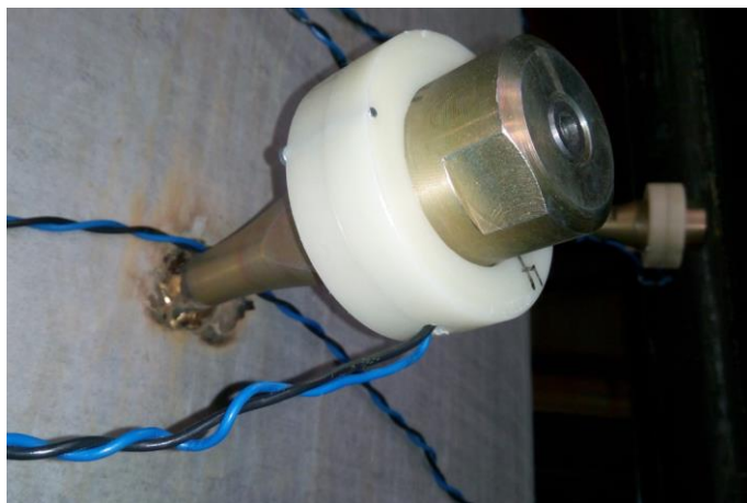
Рис. 2. Способ крепления УЗ излучателя на корпусе ионообменной колонны.
