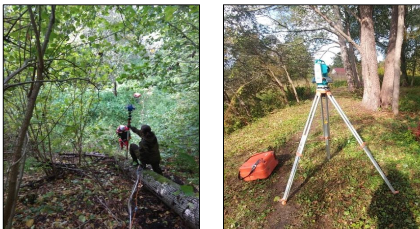
Рис. 2. Рабочий момент тахеометрической съемки
