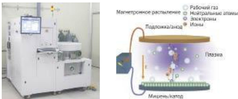
Рис. 2. Общий внешний вид (слева) и схематичное представление механизма работы (справа) магнетронной распылительной установки CS-1000 Sputter& PVD Deposition System [13]
