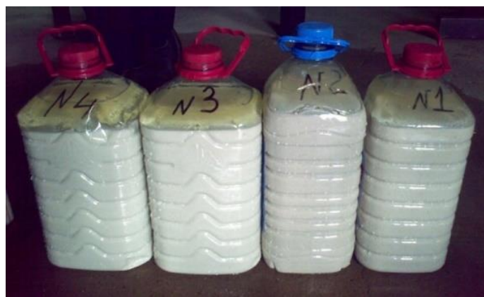
Рис. 4. Пробы исходного нового ионита (3 и 4) в сравнении с пробами ионита, бывшего в эксплуатации (1 и 2).
