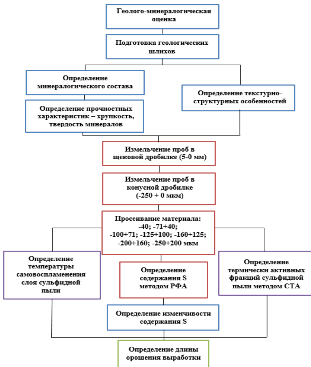
Рисунок 1. Алгоритм проведения оценки склонности сульфидной пыли к взрывоопасности
