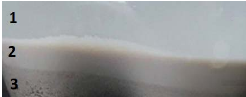
Рисунок 3. Суспензия после электрогидравлического воздействия: 1-вода 2- диатомит 3- глина
