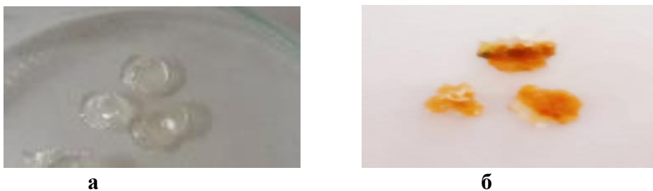
Рис. 6. Образцы синтезированных гелей: а) без включения наполнителя; б) полученные путем интеркаляционной полимеризации
