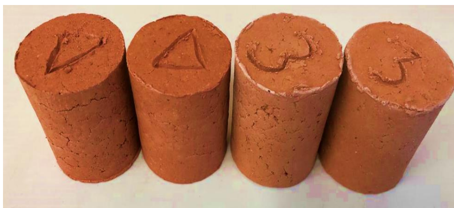
2-сурет. Фосфор қожысын қосып күйдірілгеннен кейінгі үлгілер
