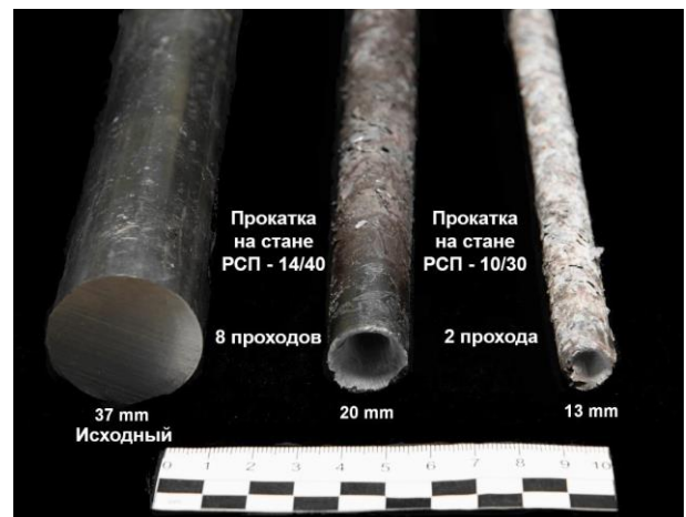
Рисунок 6. Образцы сплава Э110 по стадиям обработки
