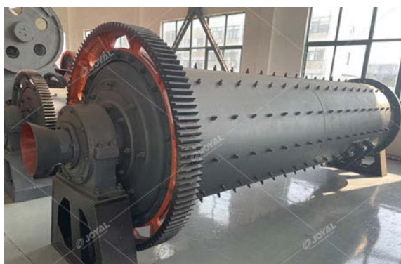
Рисунок 2. Шаровая мельница для измельчения
