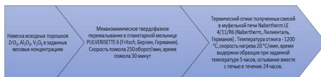
Рисунок 1. Схема получения композитных  $ZrO_2-Al_2O_3$  керамик стабилизированных допантом  $V_2O_5$
