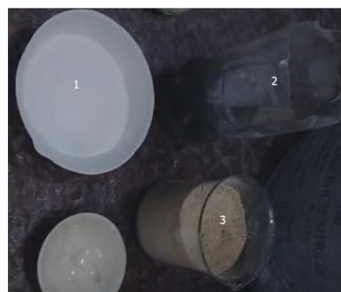
Рисунок 3. Исходное сырье для получения жаропрочных смесей: 1 – промпродукт ванадиевого производства; 2 – жидкое стекло; 3 – измельченный шамот
