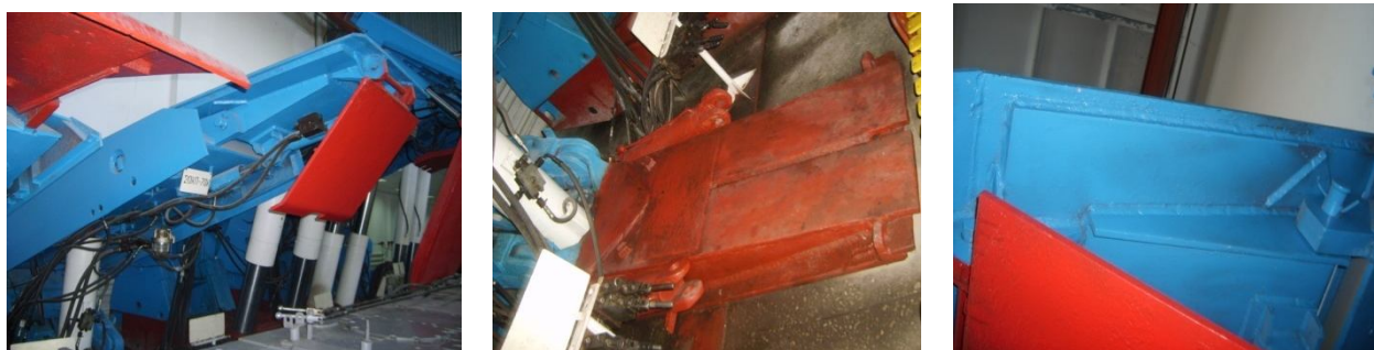
Рис. 1. Сварные соединения перекрытия и основания механизированной крепи 2ОКП70К
