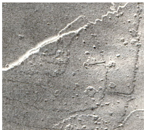
2-сурет. Полиэтилен монокристалдары (электрондық (x40000) микроскопты бейне)
