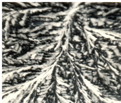
1-сурет. Полиэтилен дендриті (оптикалық (x50) микроскопты бейне)
